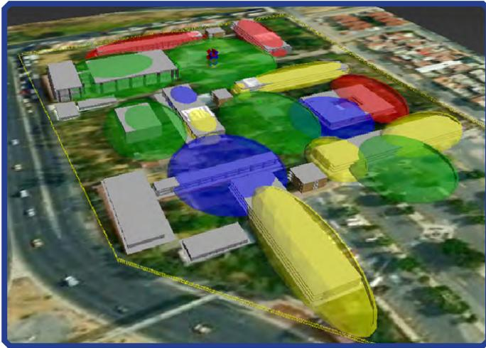
Foto 9.1. Modelos 3D generados en la planeación de coberturas de red en Campus I.
