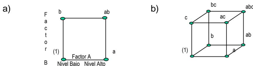
Figura 6.1. a.- Representación gráfica del diseño factorial  $2^2$
