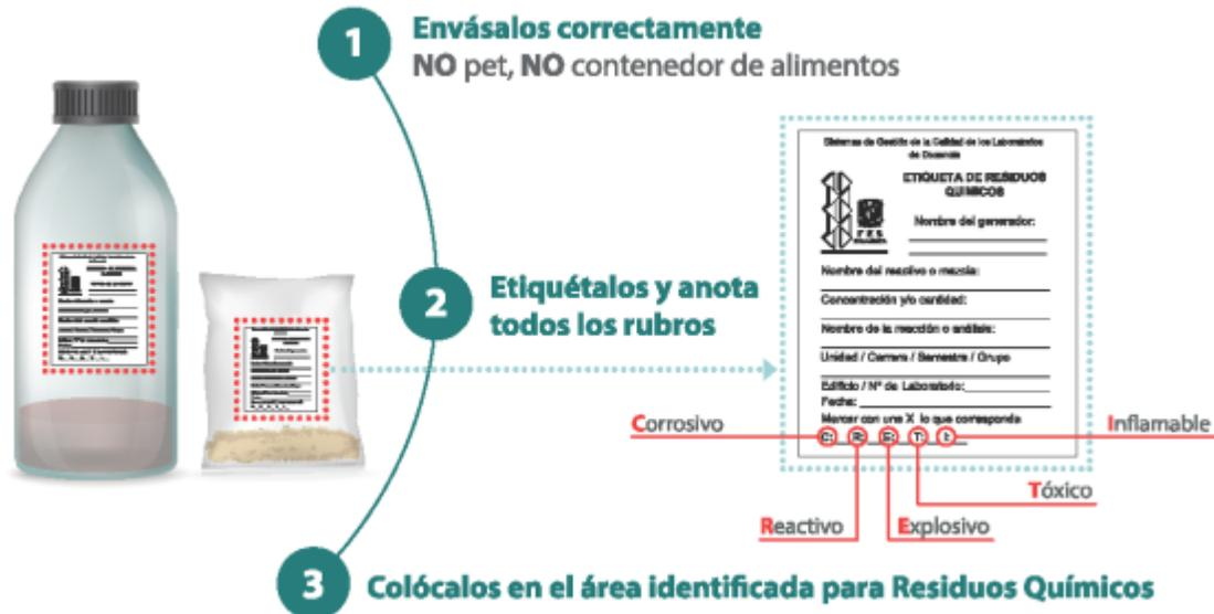
Figura 2. Etiquetado de residuos peligrosos.
