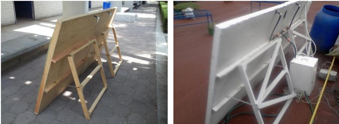
Figura 21. (a) Páneces verticales con un ángulo de 76°. (b) Vista posterior de ambos páneces terminados.
