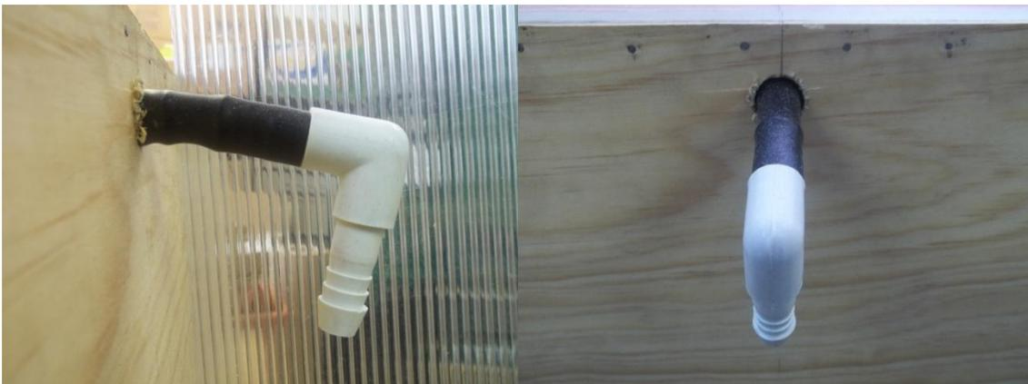
Figura 3. Conexión para el suministro del agua de riego a ambos paneles.
