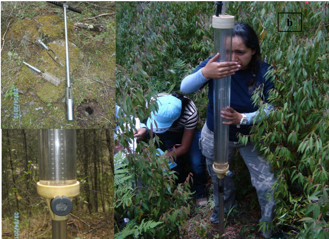
Figura 3. Inventario y medición in situ de la infiltración con el Permeámetro Guelph 2800K.
