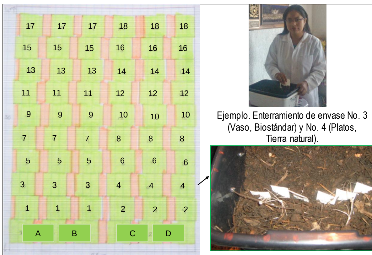
Fig. 20 Esquema de enterramiento de los envases dentro del sustrato.
