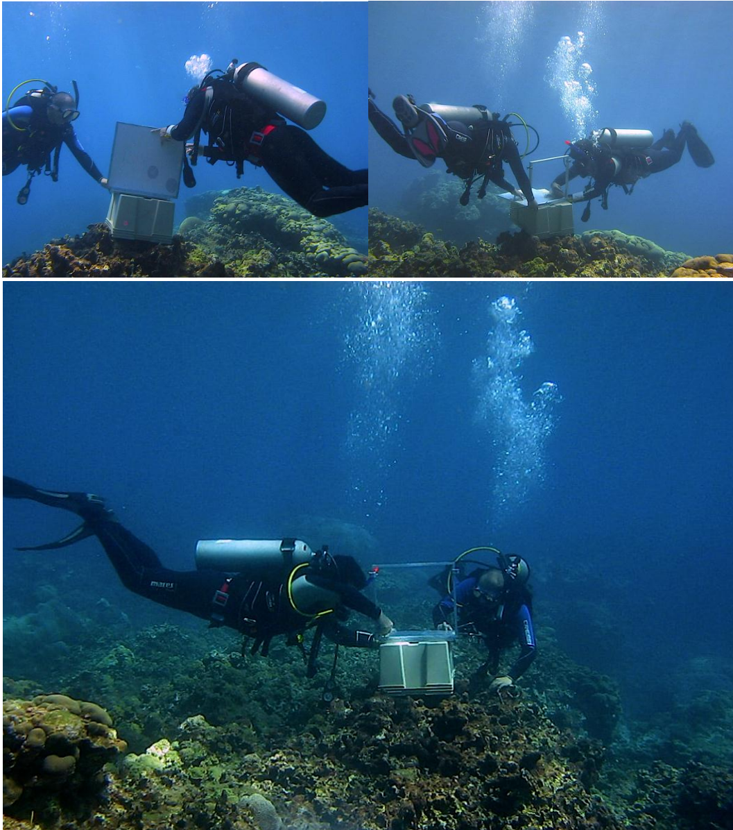
Fig. 16 Calibración del sistema estereoscópico bajo el agua. El experimento se hizo ayudado por equipo SCUBA y se llevo a cabo en el arrecife de Santiaguillo en el PNSAV, se procuro seleccionar una zona somera para evitar dañar el bentos y libre de sedimento marino para que las fotos fueran claras.
