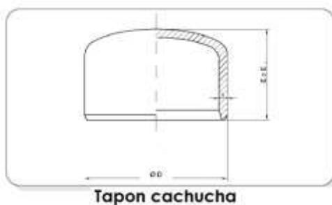
**Figura 2.6 Tapón tipo cachucha.** Fuente: Catalogo Tubos y accesorios en acero al carbono soldado y sin soldadura Normas EN (DIN) y ASTM. Tubasol S.A
