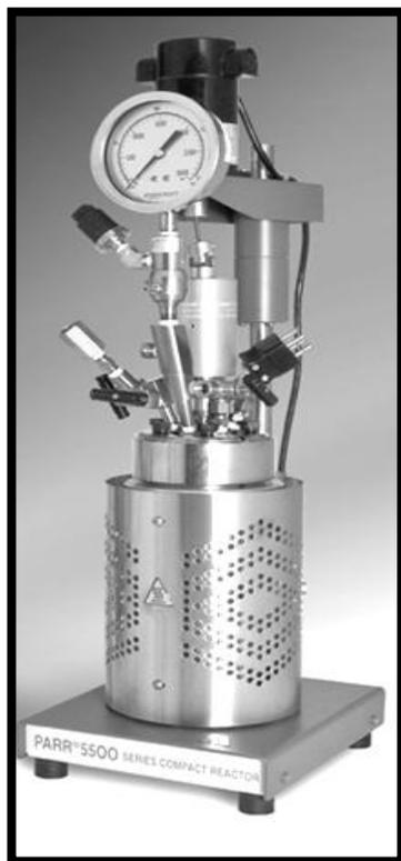
Figura 3.1 Reactor de alta presión.
