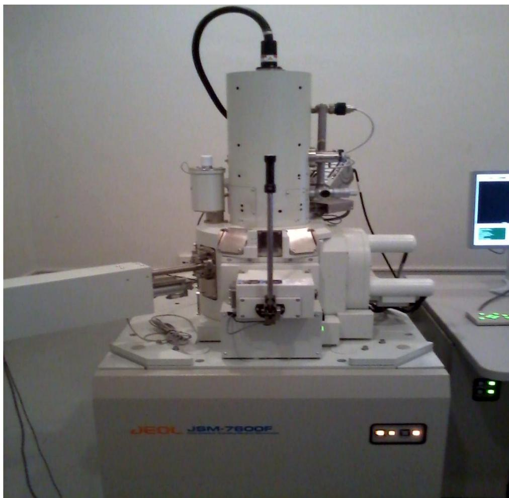
**Figura 18.** Microscopio electrónico de barrido de emisión de campo JSM-7600F
