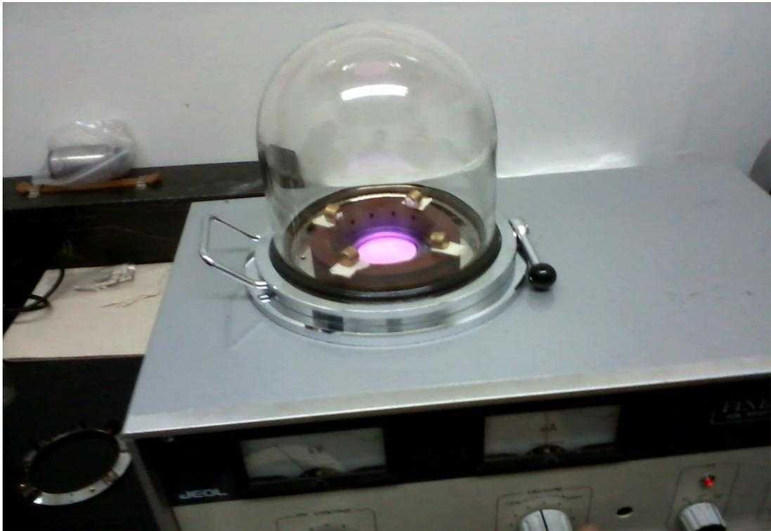
**Figura 19.** Evaporador al vacío JFC-1100 JEOL, las muestras de PP/CaCO<sub>3</sub> se están recubriendo de oro para realizar SEM.
