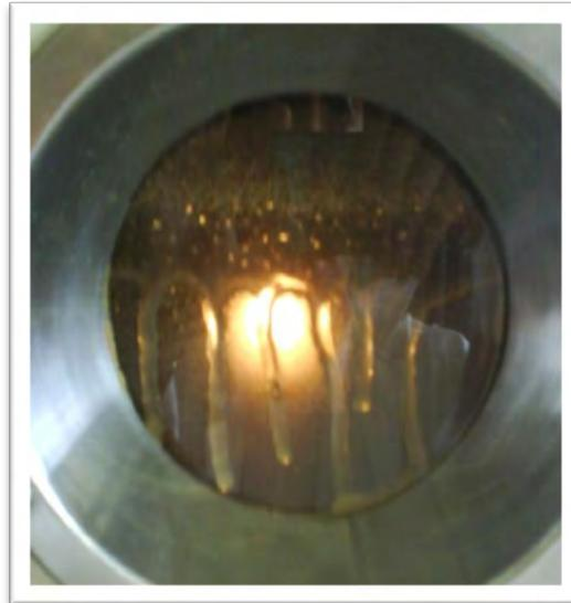
**Figura 3.11.** Problemas de escurrimiento de mucílago sobre la pared de la cámara de secado
