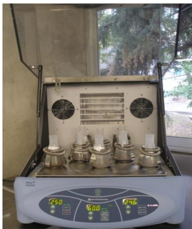
Figura 2. 3. Sistema experimental para las pruebas de adsorción (Barnstead/Lab-Line, modelo Max Q 4000).
