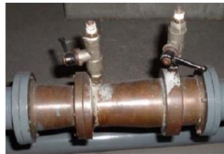
Fig.2.7. Esquema y medidor físico Venturi.
