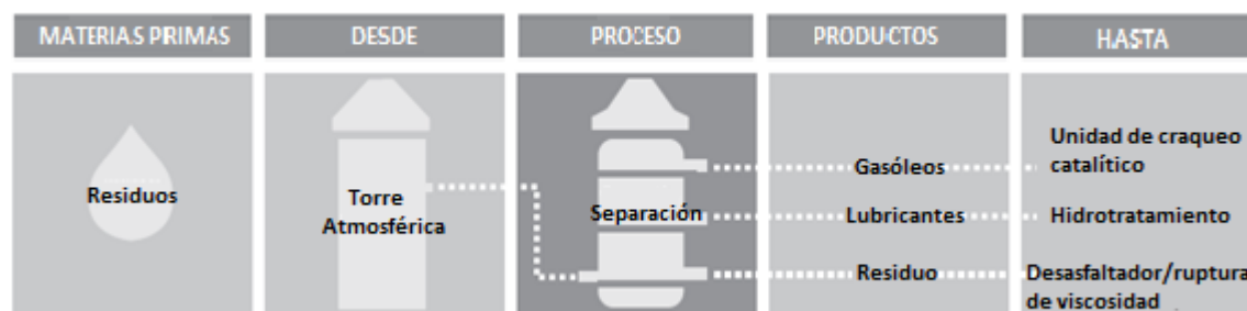
Figura 7. Proceso de destilación al vacío. 16
