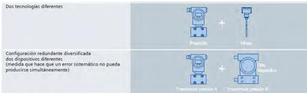
Figura 2.17. Redundancia diversificada
