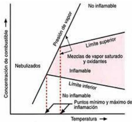
Las mezclas vapor-oxidante saturadas deben ser asociadas con la línea de presión de vapor ascendente y no con la línea vertical de la temperatura máxima de inflamación
