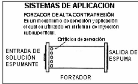
Fig. 7F Forzador de espuma a alta contra presión
