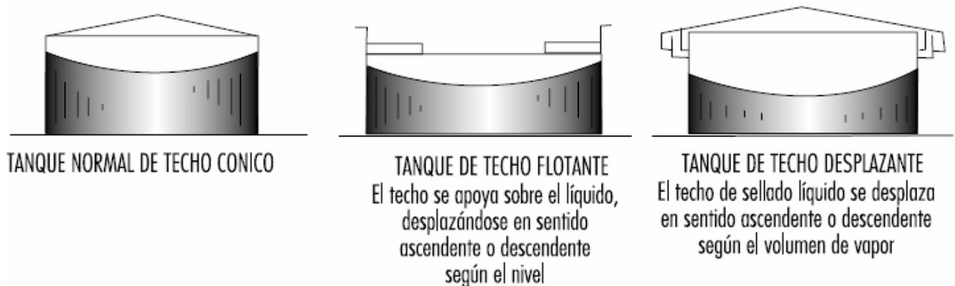
**Figura 3A Tipos más comunes de tanques para el Almacenamiento de líquidos inflamables y combustibles**
