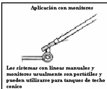
**Fig. 6I Monitor para aplicación de espuma**
