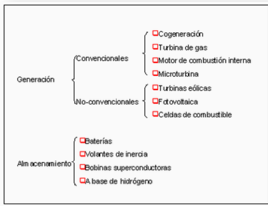
Figura 1.12 Tecnologías de Generación Distribuida.
