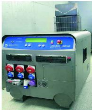
Figura 1.17 Micro-turbina Magnetek. Fuente: Labein – Tecnalia.
