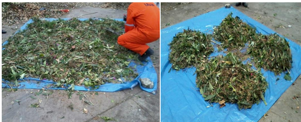
Figura 4.2 Montículo de los residuos de jardinería siendo cortados y divididos en cuatro partes conforme al método del cuarteo.
