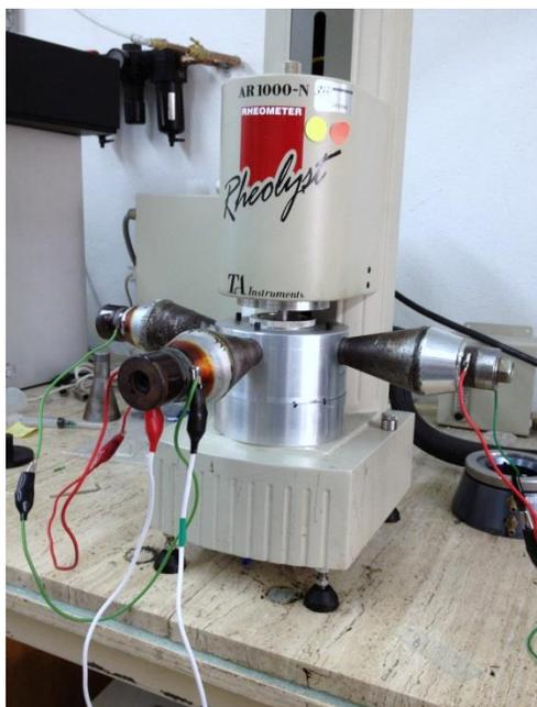
*Figura 5.10. Fotografía del dispositivo para la aplicación de Ultrasonido, una vez montado y funcionando.*
