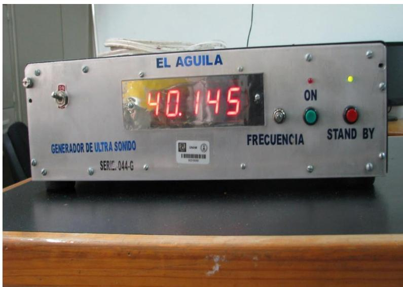
Figura 5.9. Fotografía del Generador de Ultrasonido “El Águila”.
