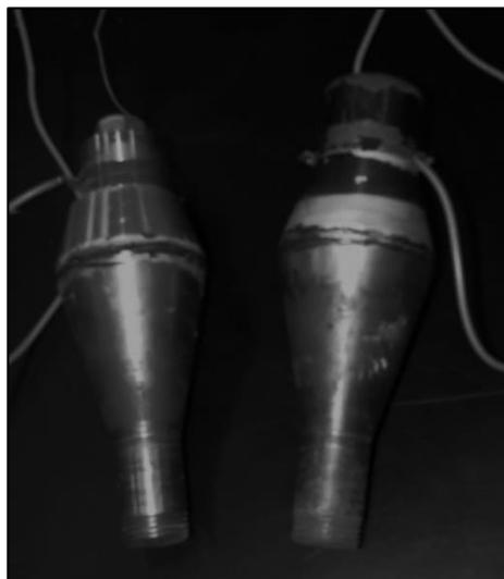
*Figura 5.3. Transductores ultrasónicos.*
