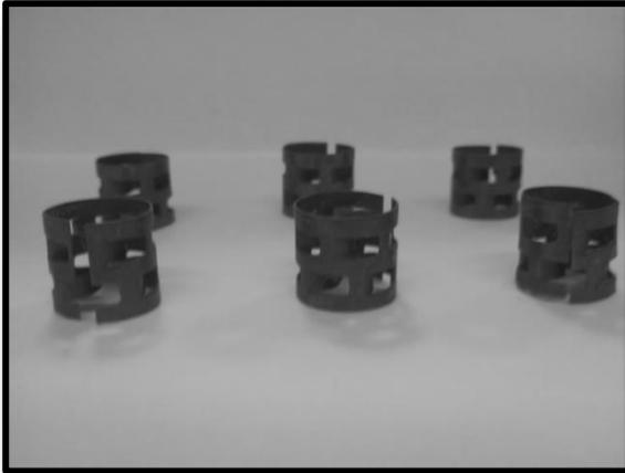
*Figura 11: Anillos pall para elaboración de dispositivo.*
