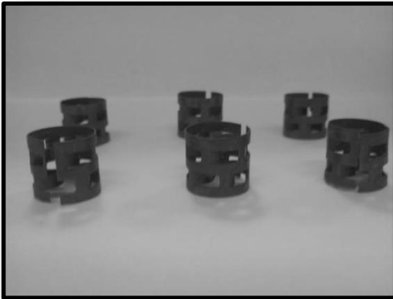
*Figura 11: Anillos pall para elaboración de dispositivo.*
