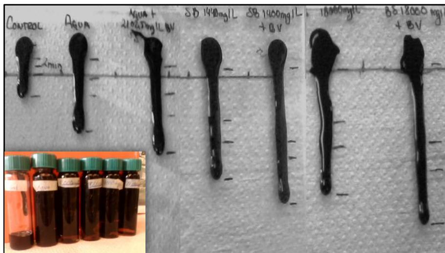
**Figura 8.11.** Efecto de los bioproductos BS y BV y su mezcla sobre el desplazamiento de crudo previamente en contacto directo con el crudo.
