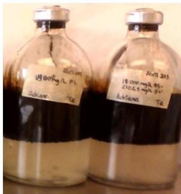
**Figura 7.4.** Sistemas de crudo con bioproductos para determinación del efecto sobre la viscosidad.
