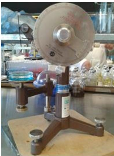
**Figura 7.6.** Tensiómetro DuNouy
