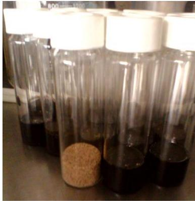
**Figura 7.3.** Sistemas de recuperación de crudo en un medio poroso.
