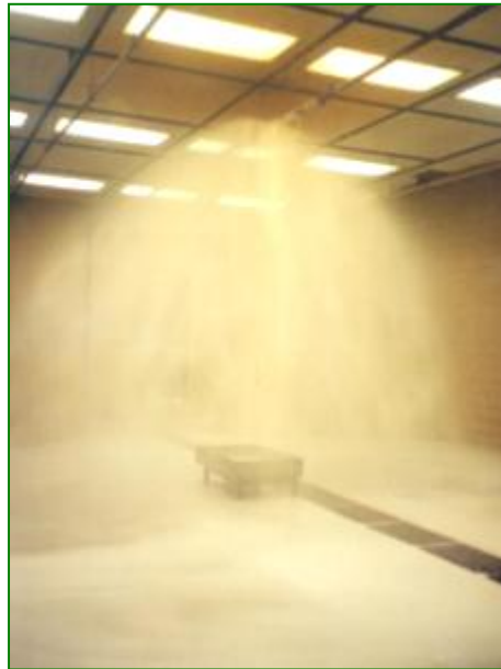
Figura no. 9 Prueba de distribución de agua de un rociador
