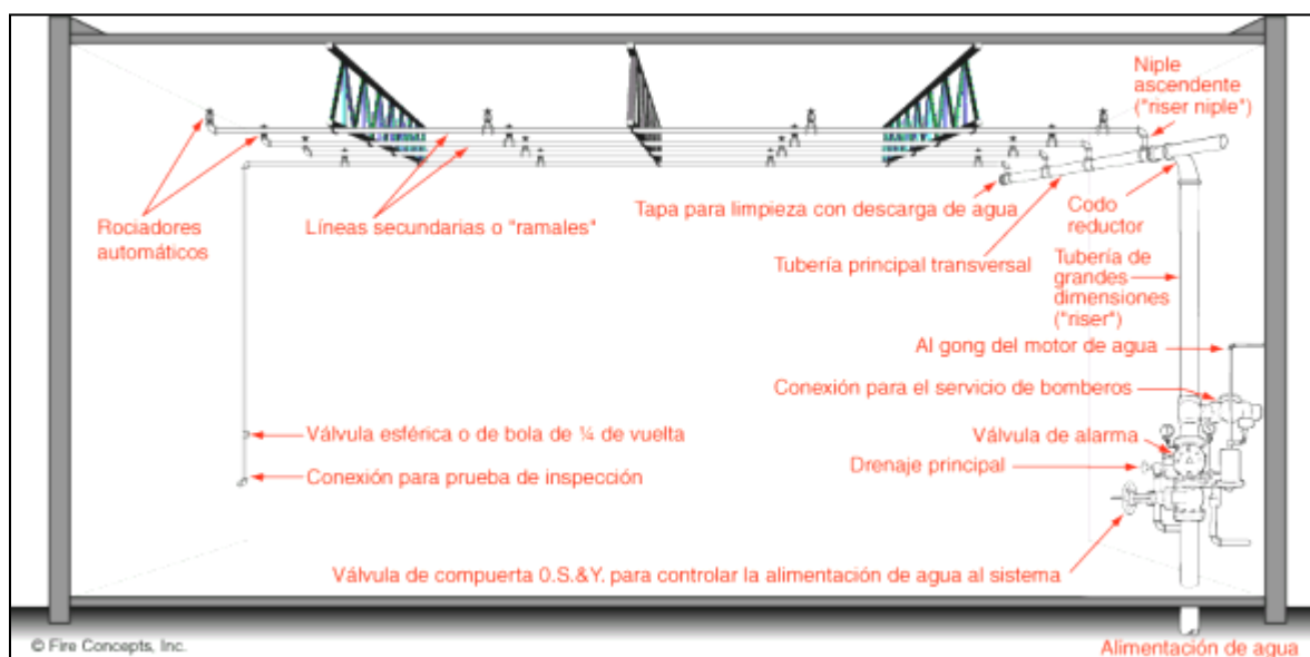
Figura no. 7 Esquema de un sistema de rociadores automáticos
