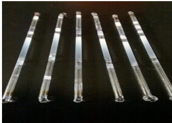
Fotografía 1. Tubos capilares + bacteria c/ Crioprotector sellados a la flama.
