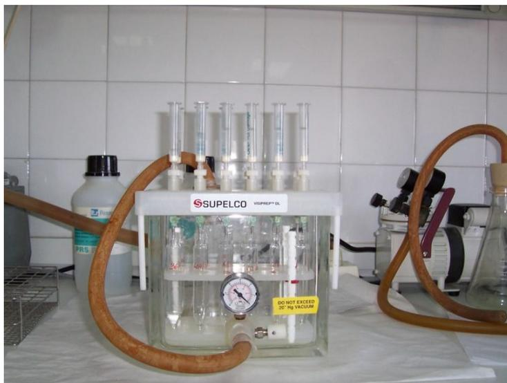
**Figura 11. Cámara de vacío para EFS**
