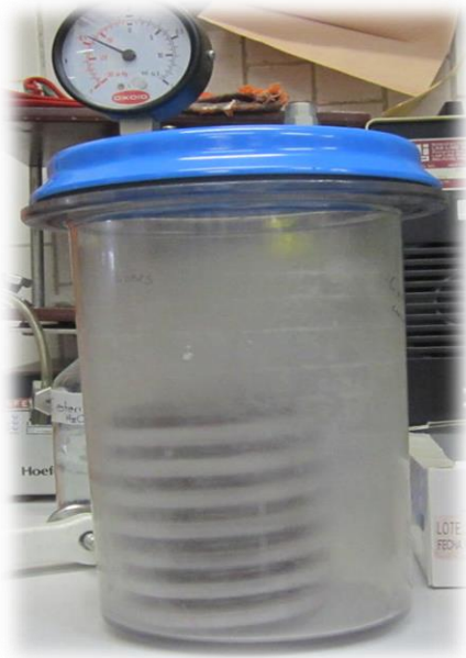
Figura 6. Jarra de anaerobiosis empleada en el cultivo de Helicobacter pylori (Tomada en INNSZ)
