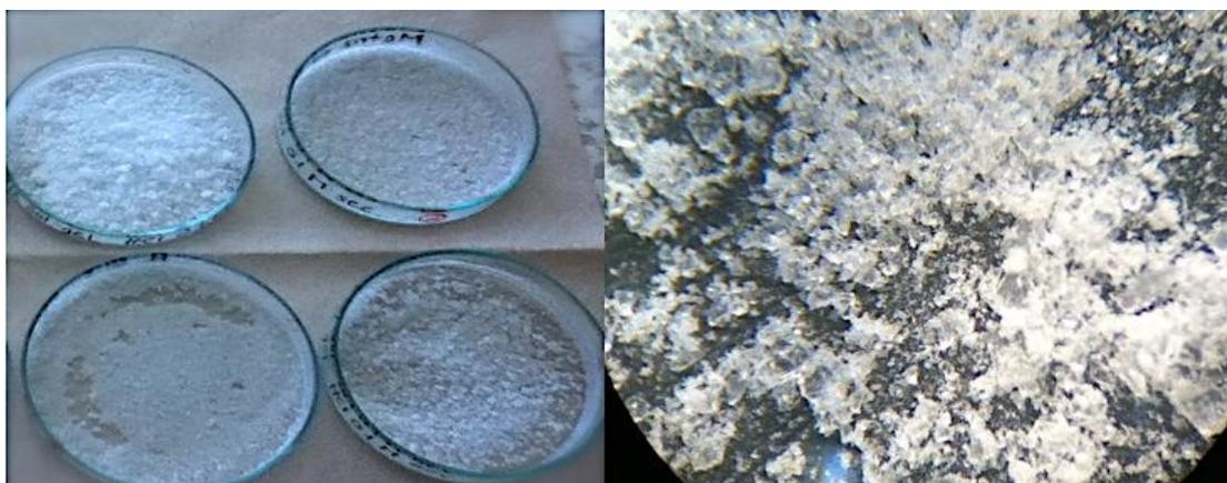
Figura 8. Matrices sol-gel sin fármaco con catalizador ácido HCl 0.1 M, seca con corriente de aire.
