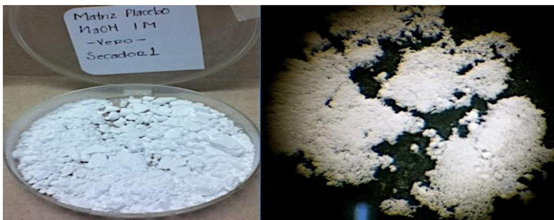
Figura 7. Matrices sol-gel sin fármaco con catalizador básico NaOH 1 M, seca con corriente de aire.
