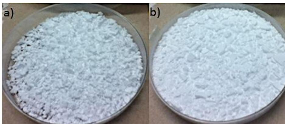
Figura 6. Matrices sol-gel sin fármaco secas a temperatura ambiente con catalizador básico: a) NaOH 0.1 M b) NaOH 1 M.
