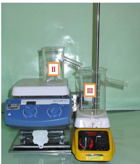
**FIGURA 3.** Compartimento periférico (vaso II) y compartimento central (vaso III) en el sistema *in vitro* para representar un MADC con administración intravenosa.
