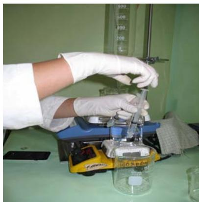
**FIGURA 7.** Toma de muestra del compartimento del compartimento central y del vaso de excretas, con ayuda de jeringas, en un sistema *in vitro* para un MADC.
