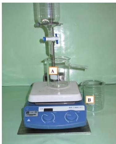
**FIGURA 3.** Ubicación del vaso de farmacocinética: comportamiento central (A) y el vaso de precipitados donde se recolectara el fluido desplazado (B), en el sistema de modelo abierto de un compartimento administración intravenosa.
