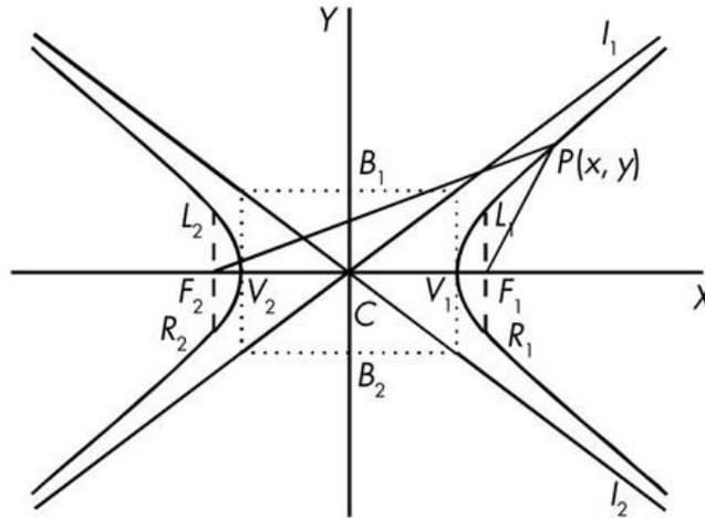
**Figura 10-7.** Sección cónica - Hipérbola[4].
