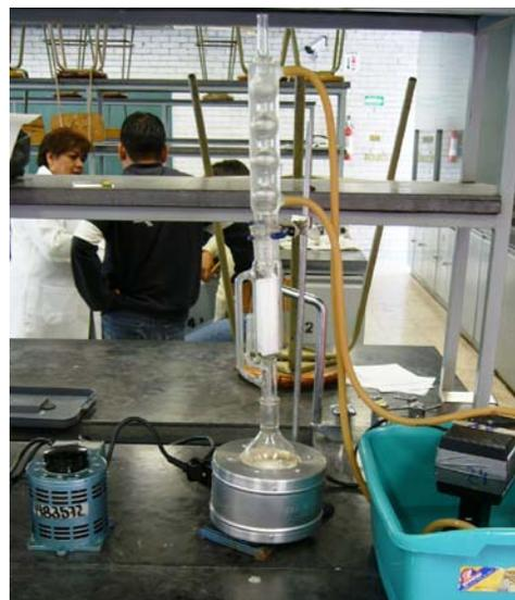
**Extracción con equipo Soxhlet**
