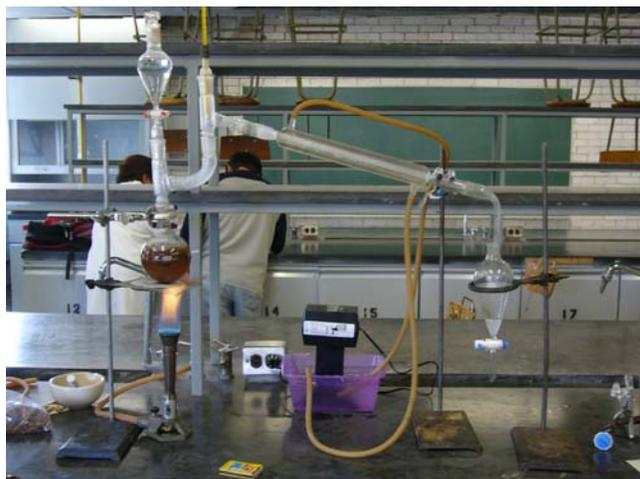
**Equipo de destilación por arrastre con vapor de agua**
