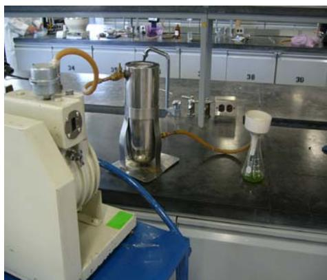
**Filtración a vacío**
