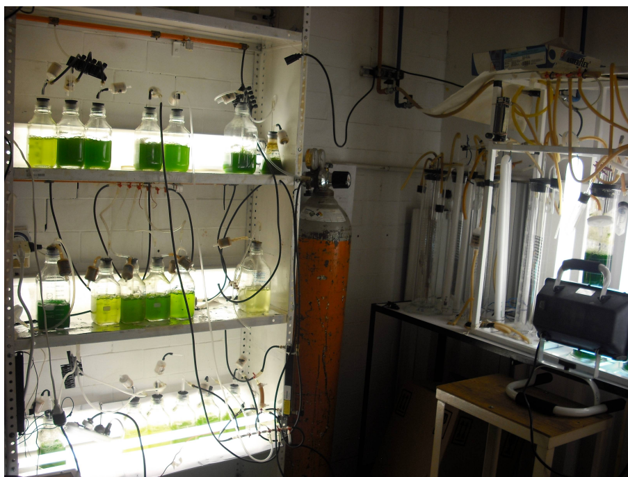
Figura 5: Cuarto de cultivo del Laboratorio de Microalgas del Departamento de Biotecnología, CINVESTAV-IPN Zacatenco. Las microalgas se utilizan con diferentes propósitos, incluida la producción de biodiesel, biofertilizantes y suplementos alimentarios, así como en la remoción de contaminantes.
