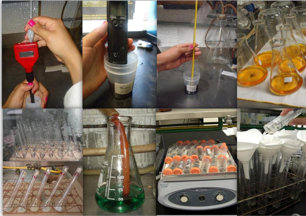
Figura 11. Parámetros en sedimento y suelo determinados en el laboratorio; arriba de izquierda a derecha: pH, conductividad eléctrica, temperatura y materia orgánica. Abajo de izquierda a derecha: nitrógeno total y fósforo extractable.
