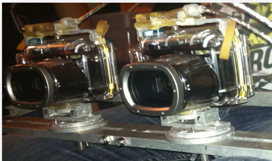
Figura 47. Mecanismo de disparo sincronizado de las cámaras: El disparo se efectúa de manera mecánica con un sistema de chicotes y pasadores, el cual activa la toma de imágenes de manera simultánea.
