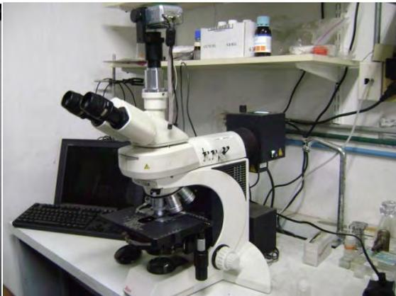
Fotos. 26y 27. Membranas de policarbonato montadas en portaobjetos y microscopio de epifluorescencia.
