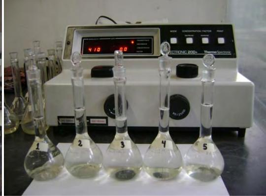
Fotos. 22 y 23. Determinación de nutrientes por técnicas colorimétricas y espectrofotometría.
