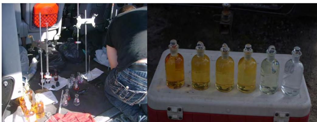
Fotos. 19 y 20. Determinación de alcalinidad y botellas DBO.
