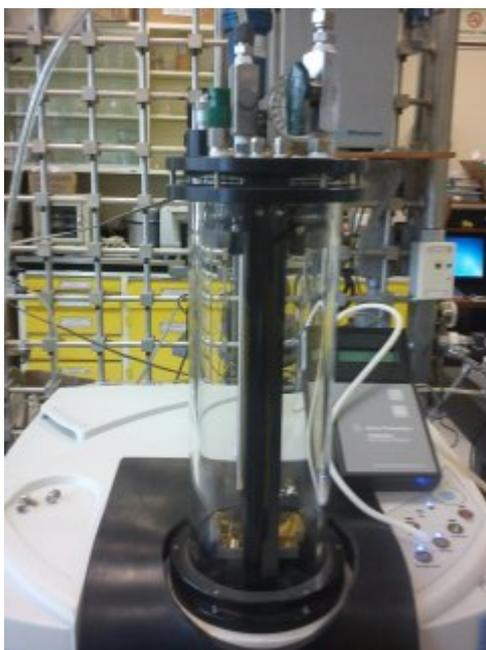
**Figura 3.4** Celda de FTIR utilizado para el seguimiento la reacción de oxidación.
