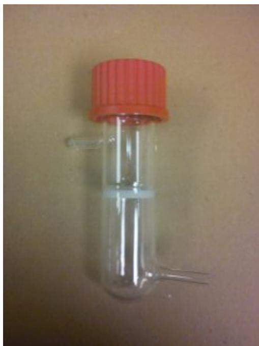
**Figura 3.5** Reactor utilizado para la reacción de oxidación.
