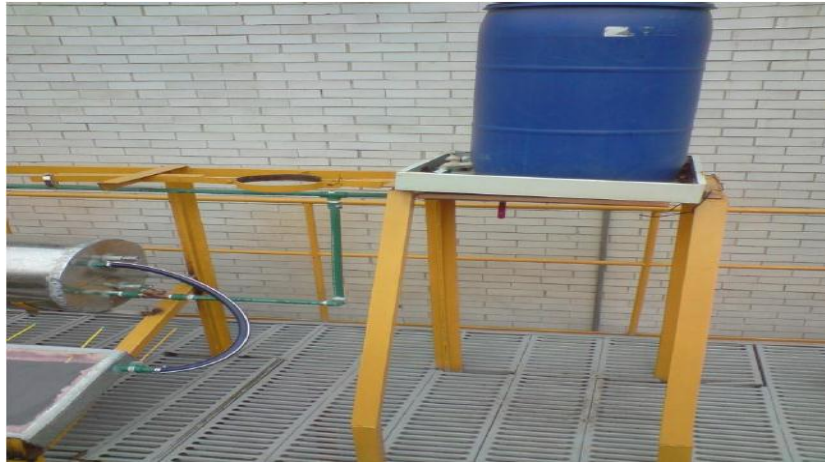
Figura 3.i Tanque de alimentación para el calentador.
