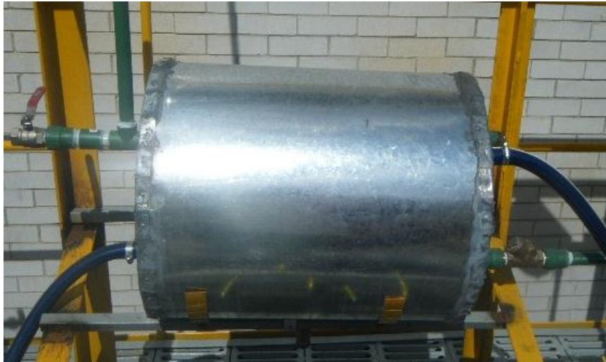
Figura 3.f Tanque de almacenamiento dentro de un recipiente de lámina galvanizada aislado con fibra de vidrio.
