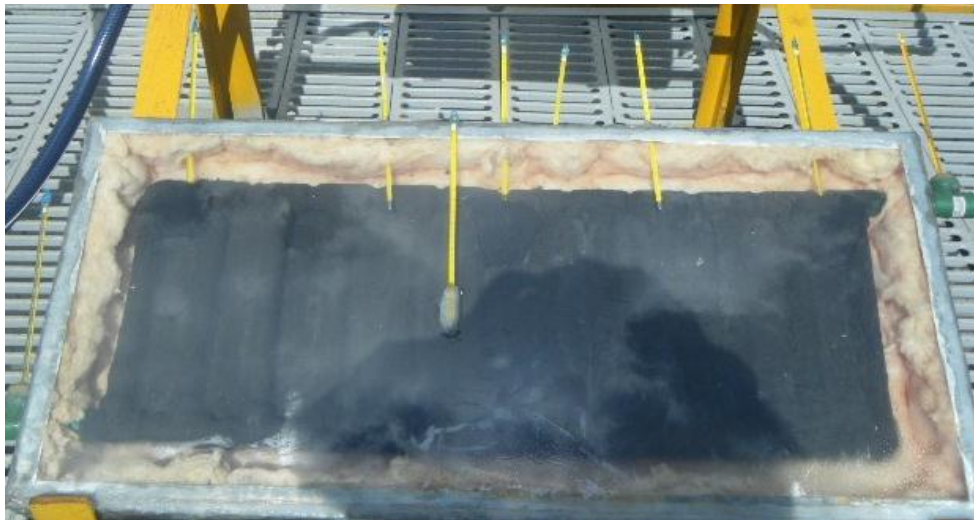
Figura 3.c Placa instalada dentro de la caja del colector con sus respectivos 9 termómetros.
