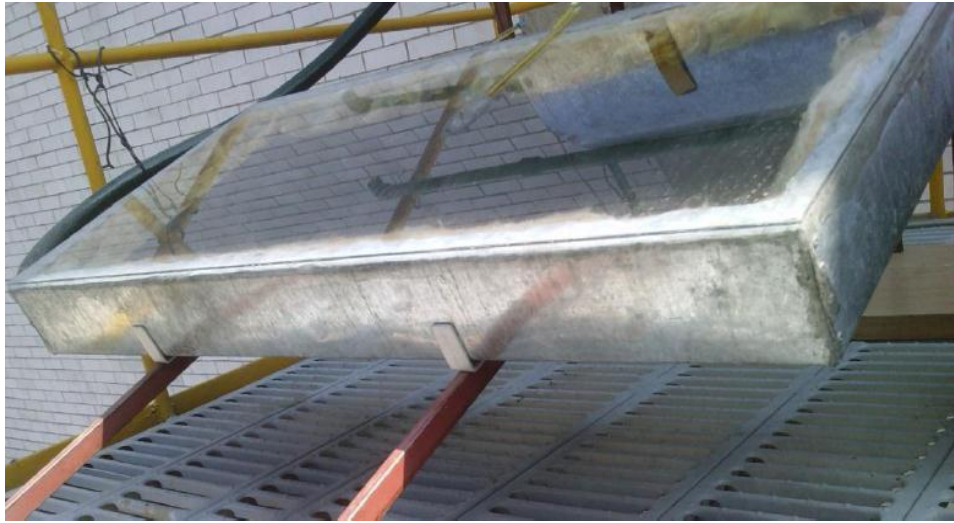
Figura 3.d Colector solar con la cubierta de vidrio pegada.
