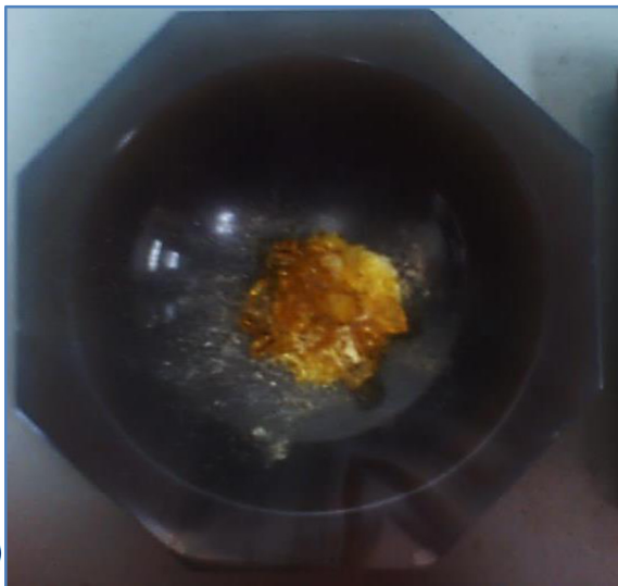
Fotografía 6-23.-Muestra 2 del sistema de \text{SiO}_2\text{-TiO}_2\text{-NiO} : a) Xerogel, b) Xerogel triturado
