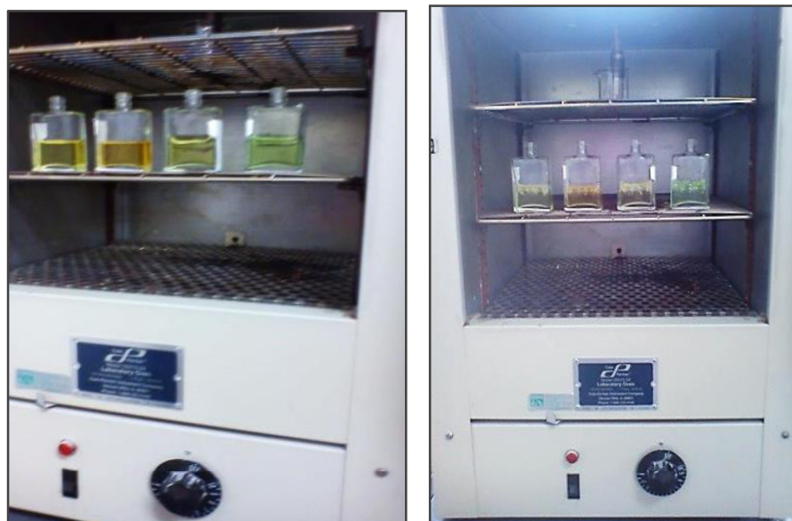
Fotografía 6-14.- Secado de las muestras en el horno a 60°C
