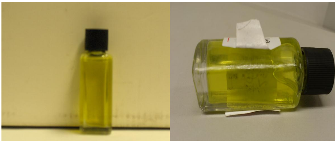
Figura 2. Soles de SiO 2 -TiO 2 -NiO transparentes, recién preparado y gelificado.
