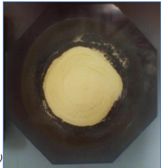
Fotografía 6-27.-Muestra 3 del sistema de \text{SiO}_2\text{-TiO}_2\text{-NiO} : a) Xerogel, b) Xerogel triturado
