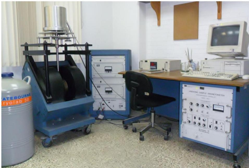
Figura 3.7 Magnetómetro de Muestra Vibrante
