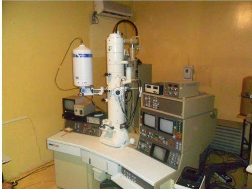
Figura 3.6 Microscopio Electrónico de Transmisión
