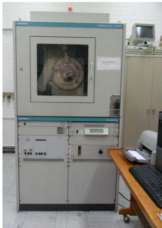
Figura 3.4 Difractómetro de Rayos X.
