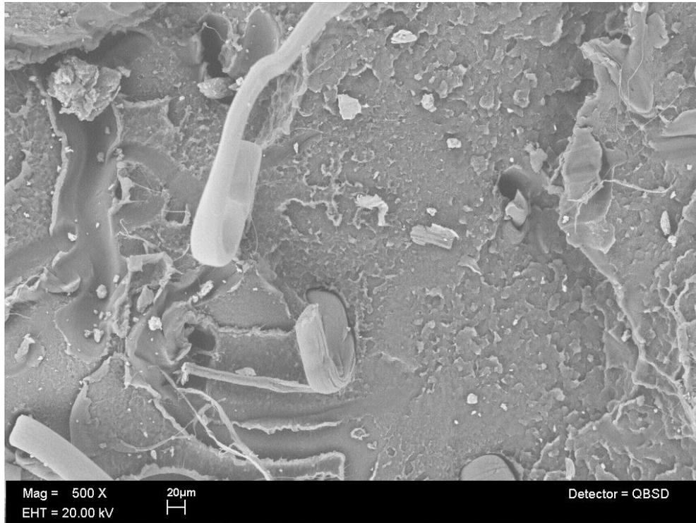
Figura 26 (a). Morfología de la mezcla "2.5": HDPE+2 phrPE-G-MAH+20 phr de mezcla "2.1"
