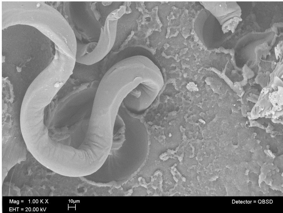
Figura 27 (a). Morfología de la mezcla "2.5": HDPE+2 phr PE-G-MAH+30 phr de mezcla "2.1"
