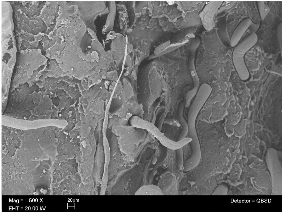
Figura 28 (a). Morfología de la mezcla "2.5": HDPE+2 phr PE-G-MAH+40 phr de mezcla "2.1"
