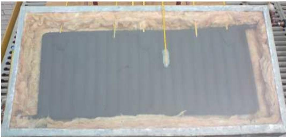
Figura 3.1 Colector solar de placa plana armado
