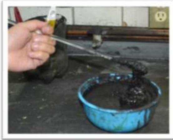
Figura 4.4.4 Consistencia de la mezcla (carbón y mucílago de nopal)
