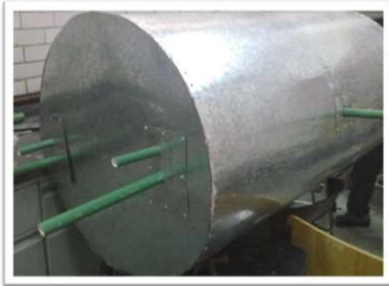
Figura 4.6.6 Termotanque aislado y con envolvente
