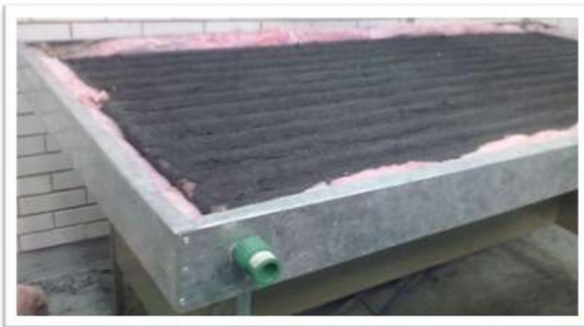
Figura 4.4.10 Placa colocada dentro de la carcasa
