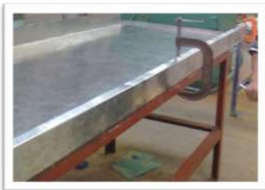
Figura 4.2.4 Lámina sujeta con prensas
