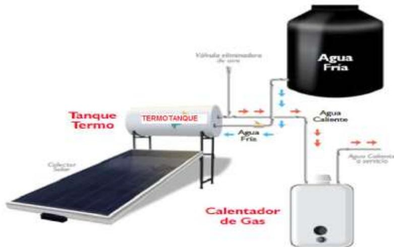
Figura 4.7.2 Esquema de Instalación de calentador solar
