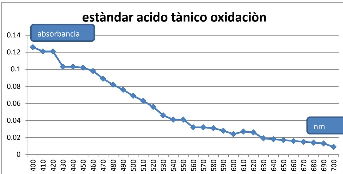
**Grafico 9.** Espectro registrado de manera puntual, que muestra la disminución de la respuesta analítica en la región visible en una solución estándar de ácido tánico degradado por oxidación en medio ácido, haciendo uso de peróxido de hidrogeno al llevar a cabo la reacción con yodato de potasio al 2.5% en la región visible, dicha disminución se debe únicamente a aquellos taninos que continúan intactos, lo cual demuestra que el método propuesto es indicativo de estabilidad.
