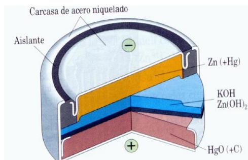
Figura 4. Estructura de la pila botón<sup>59</sup>
