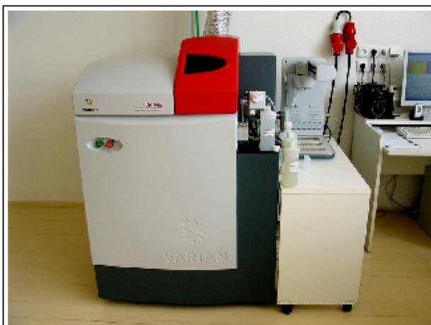
*Figura No. 21. Plasma acoplado inductivamente con espectrómetro de masas (ICP-MS)*
