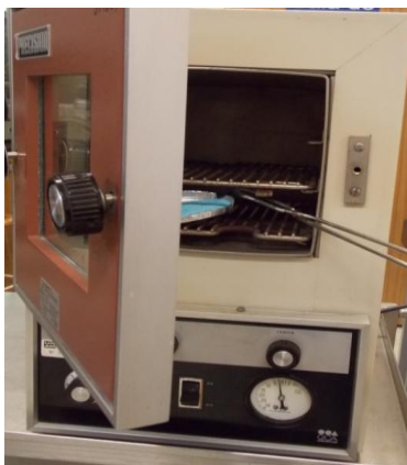
Fotografía 6. Secado en estufa de vacío, (obtención propia).
