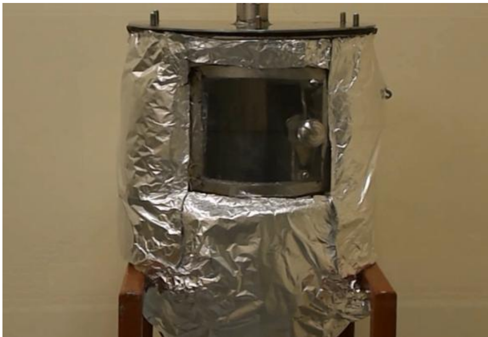
Fotografía 16. Secador de lecho fluidizado, (obtención propia).
