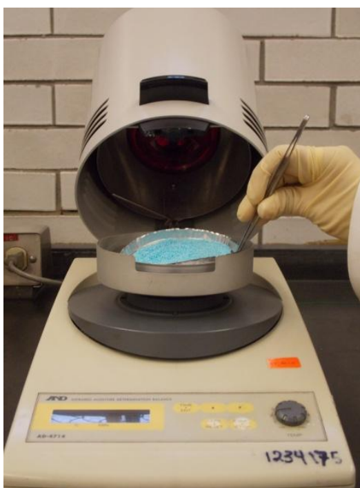
Fotografía 18. Secador por radiación infrarroja, (obtención propia).
