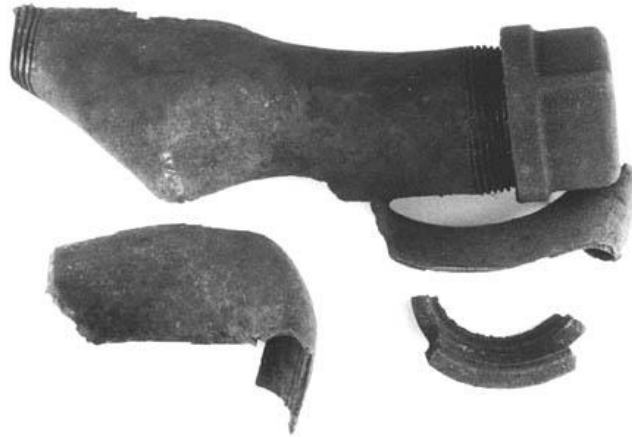
Figura 1. Daño producido a una tubería (10 pulgadas de largo por 1.5 de ancho) causado por pólvora.
