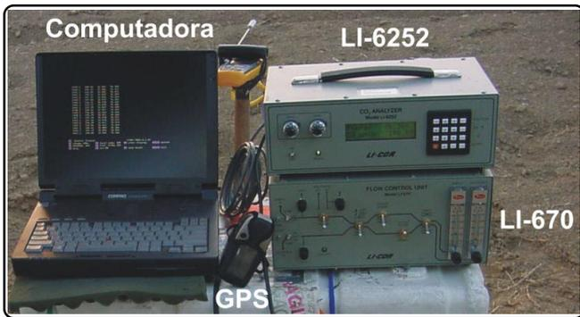
Figura 3. Componentes del sistema de medición: computadora Lap-Top, analizador infrarrojo de CO<sub>2</sub>, unidad de flujo y GPS portátil.
