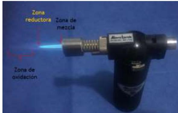
Fig. 23 Se muestra la zona de la flama adecuada para soldar. Fuente directa Arturo Torres Sánchez
