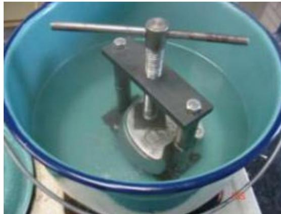
Figura 8. Termocurado del acrílico durante 1 hora 30 minutos
