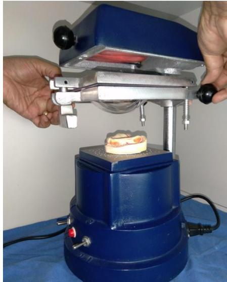
Figura 13 Matriz de acetato sometida al calor y formación de burbuja.
