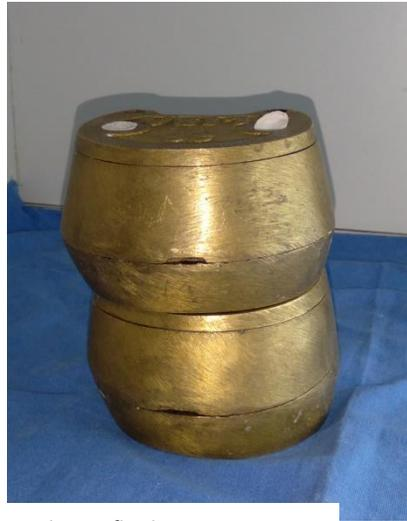
Figura 2a y 2b respectivamente con las mufas listas para ser abiertas.
