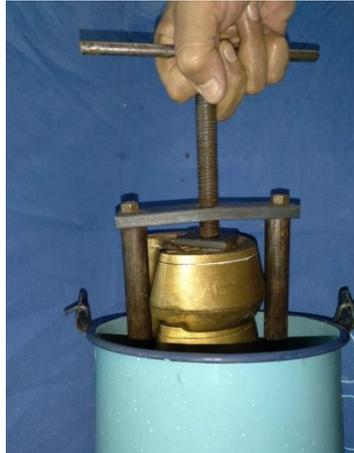
Figura 1 Sacar del agua fría las mufas adjunto a la prensa
