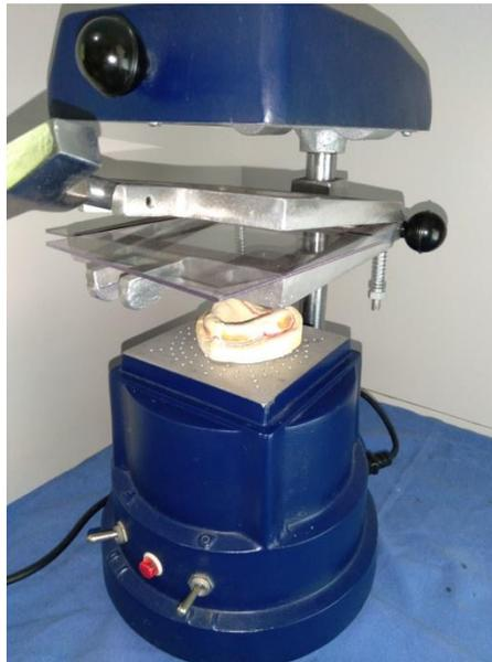
Figura 12 Colocación de la Matriz de acetato y del modelo.
