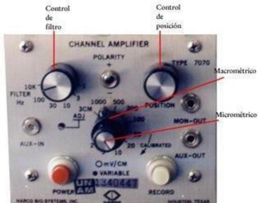
Dependiendo del fenómeno en estudio, el amplificador se acoplará a un preamplificador o a un transductor. El preamplificador se usa cuando la variable es una señal bioeléctrica, por ejemplo la toma del electroencefalograma o del electrocardiograma
