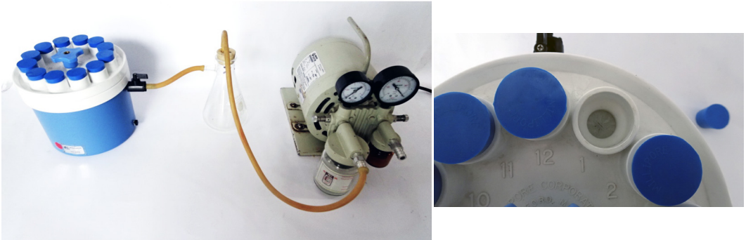
FIGURA 4.2. Sistema de filtración Millipore, en cada espacio se filtra una muestra.
